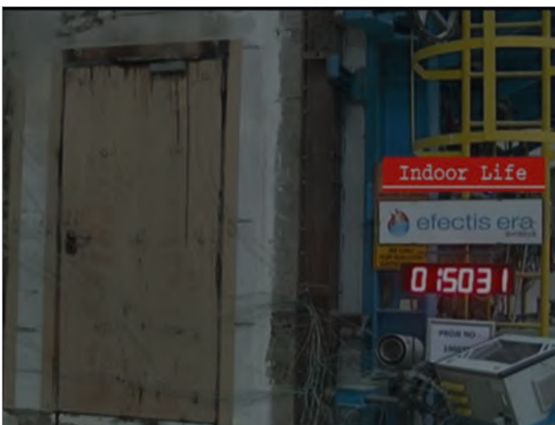
Die Tür beginnt nach 1 Stunde 50 Minuten zum Brennen an.
