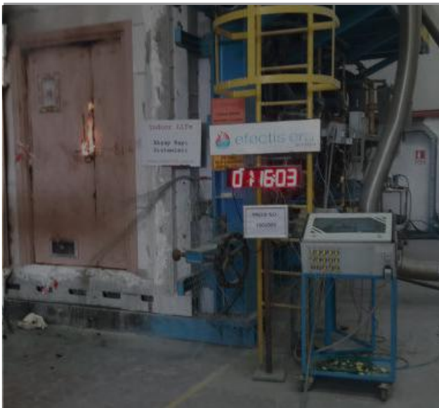
Die Tür beginnt nach 1 Stunde 16 Minuten zum Brennen an.
